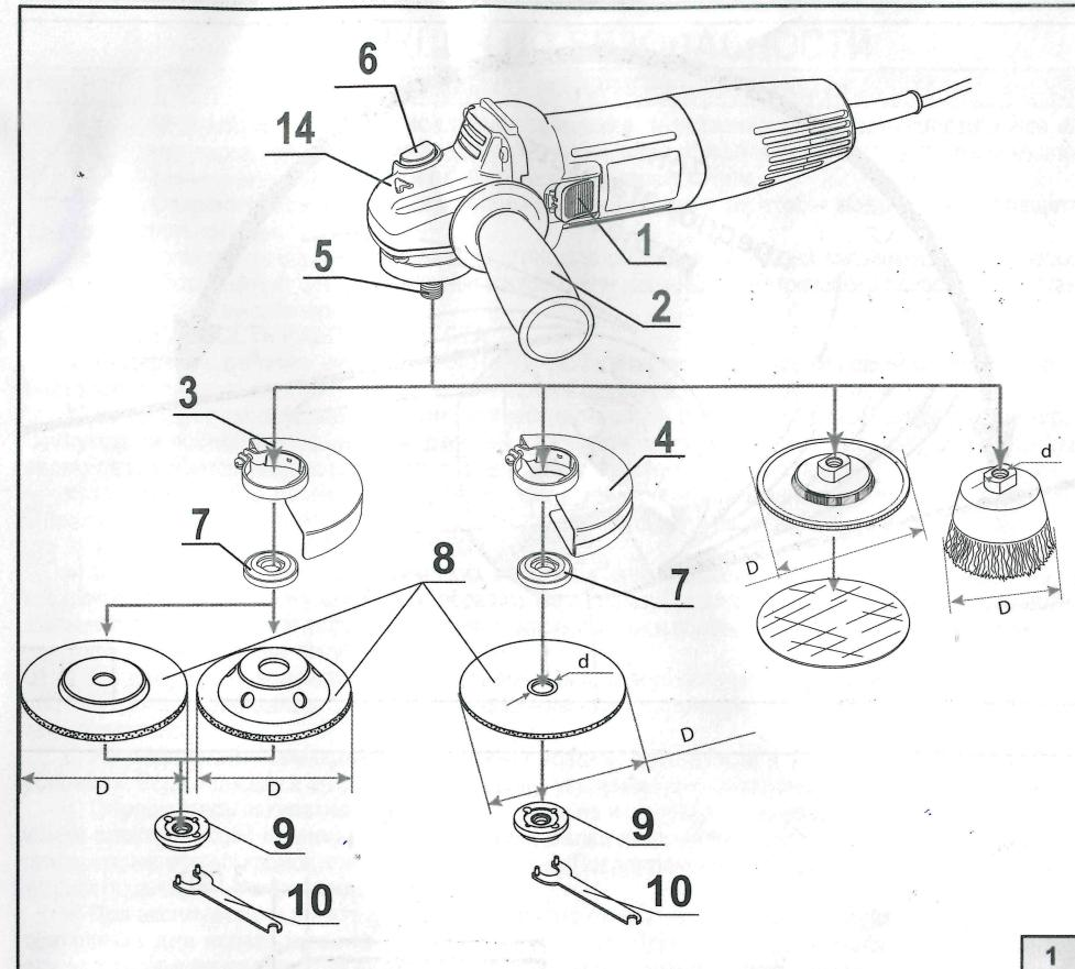
D - Максимальный Ø диаметр рабочего инструмента;
